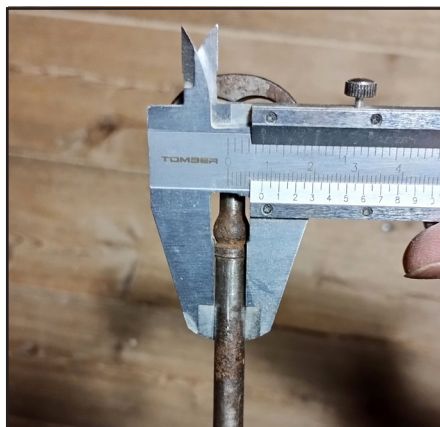
Pyöreän varren halkaisijan mittaaminen onnistuu tarkimmin työntömitalla.
