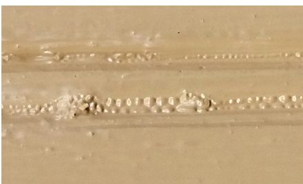
Uriin jäänyt suuri määrä maalia kuivuu hitaasti ja krumpääntyy.
